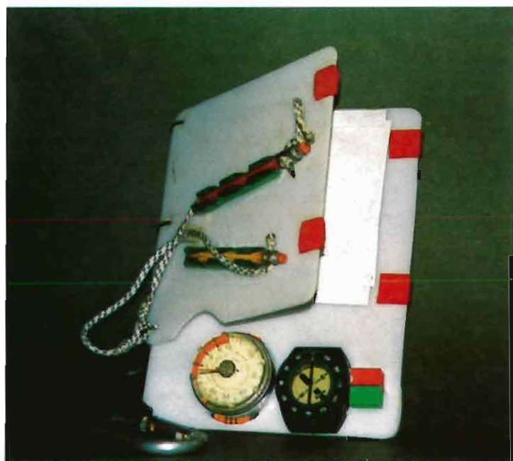
Quaderno da rilievo per speleo-subacquei autocostruito mod. ideato da Spartaco Savio)
