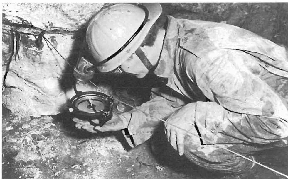
Rilievo di precisione, con l'utilizzo della bussola da miniera, nelle grotte vaporose del Monte Kronio (Sciaccia) nel 1962 (Foto Archivio S.A.G.)
