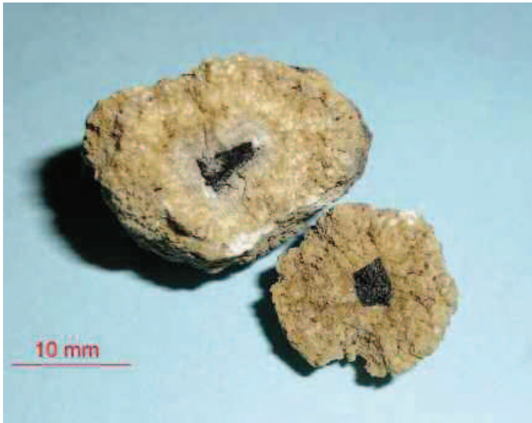
Fig. 9: struttura interna di due pisoliti del tipo 2. Il nucleo è costituito da un frammento di legno carbonizzato.
