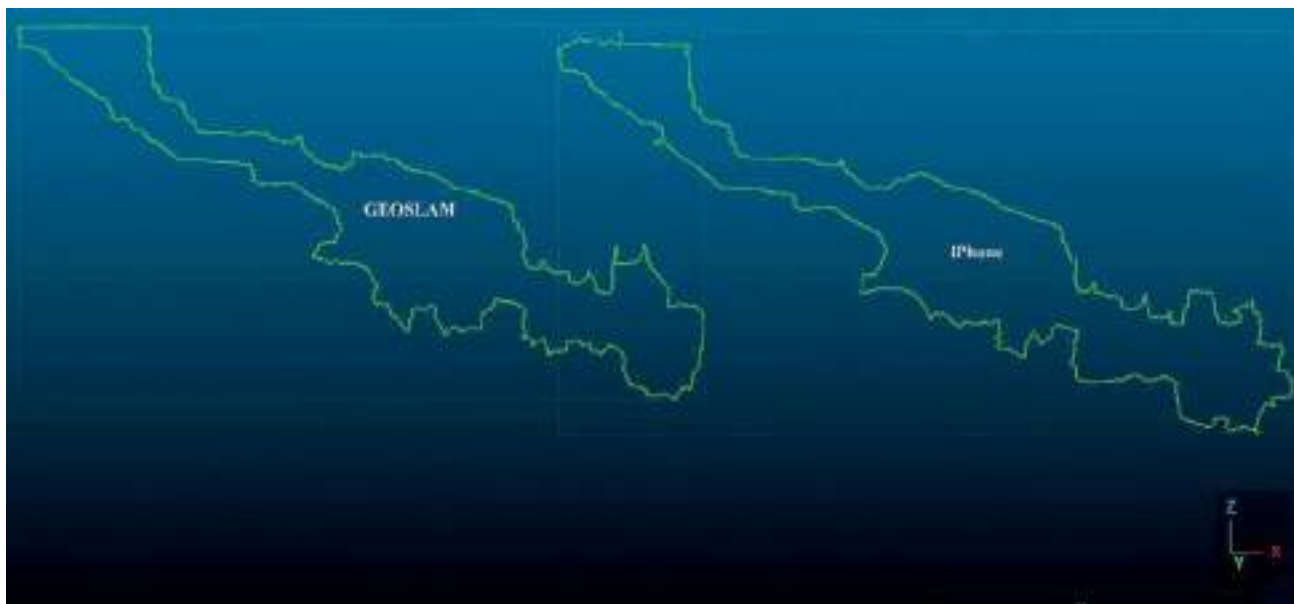
Fig. 1 - Confronto fra i risultati ottenuti nel rilievo della Grotta delle Torri di Slivia (22/39VG) effettuato con GeoSlam e iPhone.
