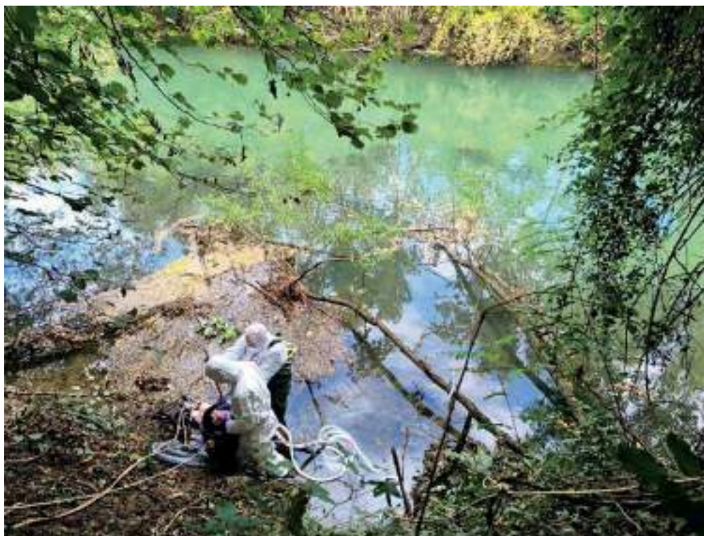
Fig. 1 - Le operazioni di iniezione del tracciante in sponda sinistra del Fiume Vipacco il 30 settembre 2024.
