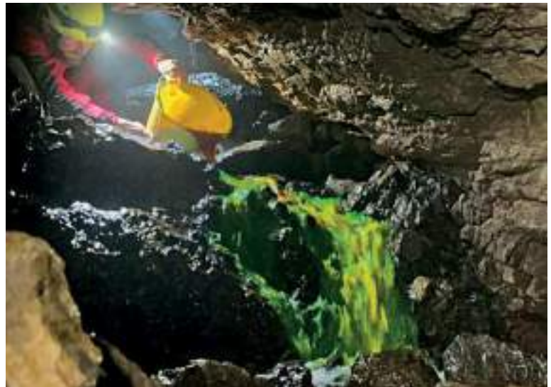
Fig. 5 - Iniezione di uranina nel Pozzo della confluenza.
