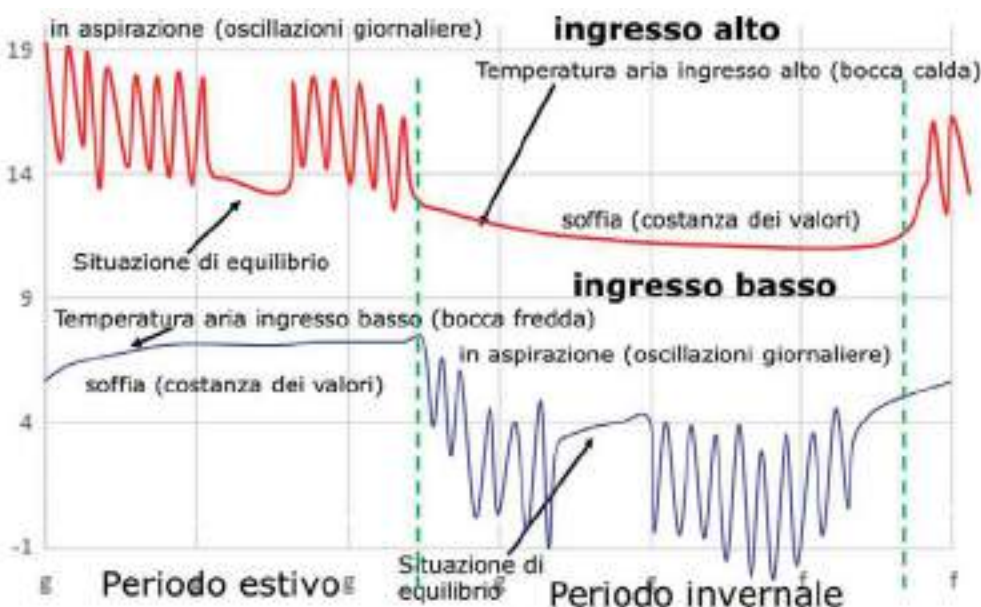
Fig. 6 - Modello concettuale relativo alla circolazione dell'aria basato sui valori di temperatura presso un ingresso alto (in rosso) e un ingresso basso (in blu) e a pavimento e soffitto in una cavità con una circolazione "a sacco d'aria" (da VIGNA, 2023).
