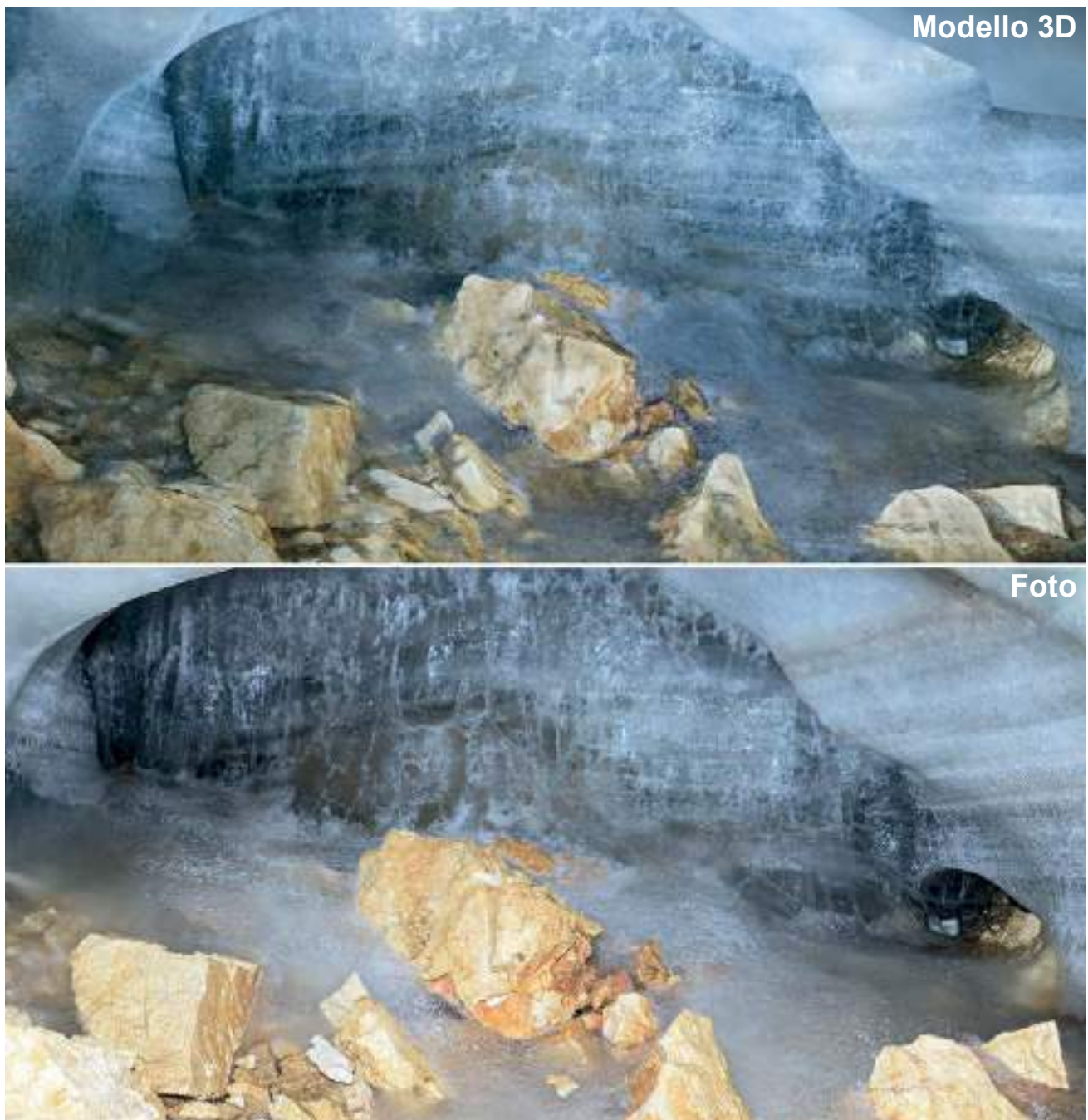
Fig. 4 - Esempio di restituzione realistica del modello 3D ricostruito dalla nuvola di punti (sopra) messo a confronto con una fotografia della medesima area della grotta (sotto).
